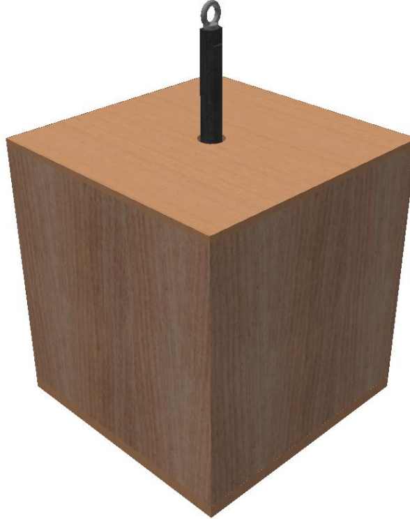
Abbildung 4: ROTU S in Transportkiste mit Transportöse der Transportstange
