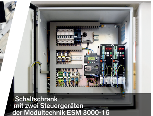
Lineare Zuführanlage mit einem SLF 1000-1000 - Steuerung über eine ESM 3000-16 (Abb. rechts) & ein SLL 400-800 mit Gabellichtschranke - Steuerung über eine ESM 3000-16 (Abb. rechts)
