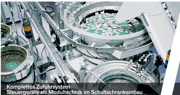
Lineare Zuführanlage mit einem SLF 1000-1000 - Steuerung über eine ESM 3000-16 (Abb. rechts) & ein SLL 400-800 mit Gabellichtschranke - Steuerung über eine ESM 3000-16 (Abb. rechts)
